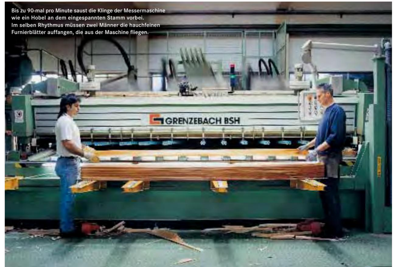
Bis zu 90-mal pro Minute saust die Klinge der Messermaschine wie ein Hobel an dem eingespannten Stamm vorbei. Im selben Rhythmus müssen zwei Männer die hauchfeinen Furnierblätter auffangen, die aus der Maschine fliegen.
