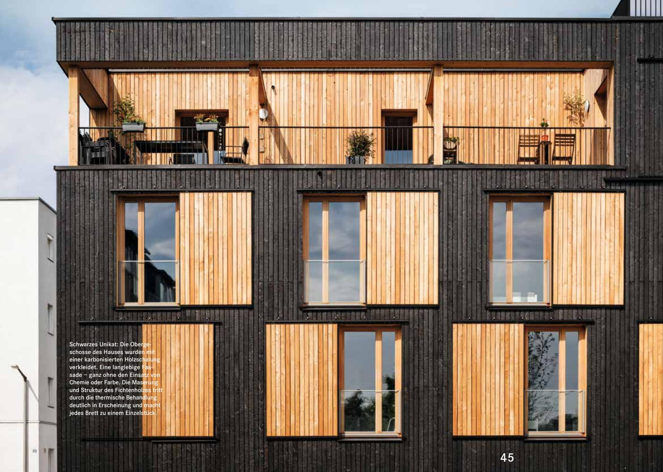
Schwarzes Unikat: Die Obergeschosse des Hauses wurden mit einer karbonisierten Holzschalung verkleidet. Eine langlebige Fassade – ganz ohne den Einsatz von Chemie oder Farbe. Die Maserung und Struktur des Fichtenholzes tritt durch die thermische Behandlung deutlich in Erscheinung und macht jedes Brett zu einem Einzelstück.
