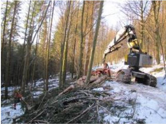
Abb. 66: Einsatz des Spezialharvesters mit Seilwinde
