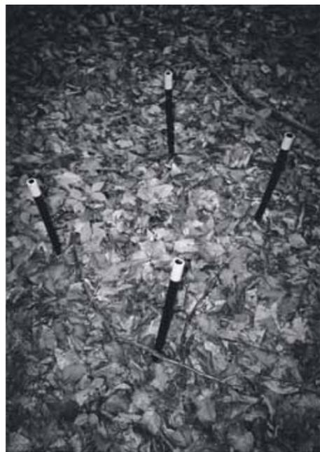
Achtung Forschung: Zwischen den vier Abstandsmarkierungen ist ein Plastikgefäß unter dem Humus verborgen. Im sogenannten Lysimeter werden die Depositionen in den Niederschlägen genau erfasst.
