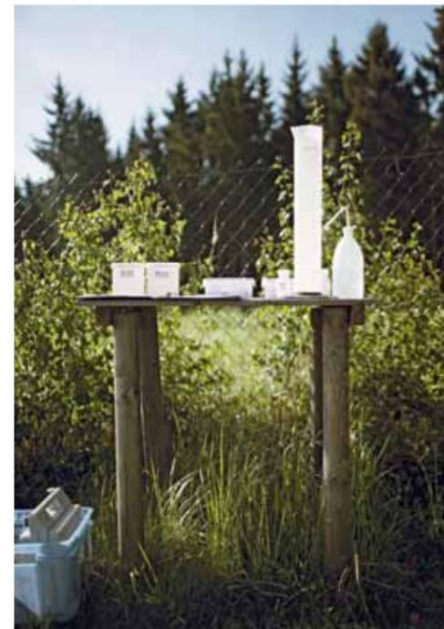
Auf einem minimalistischen Labortisch werden die Entnahmen aus den Sammelgefäßen zu Mischproben zusammengegossen (oben).
