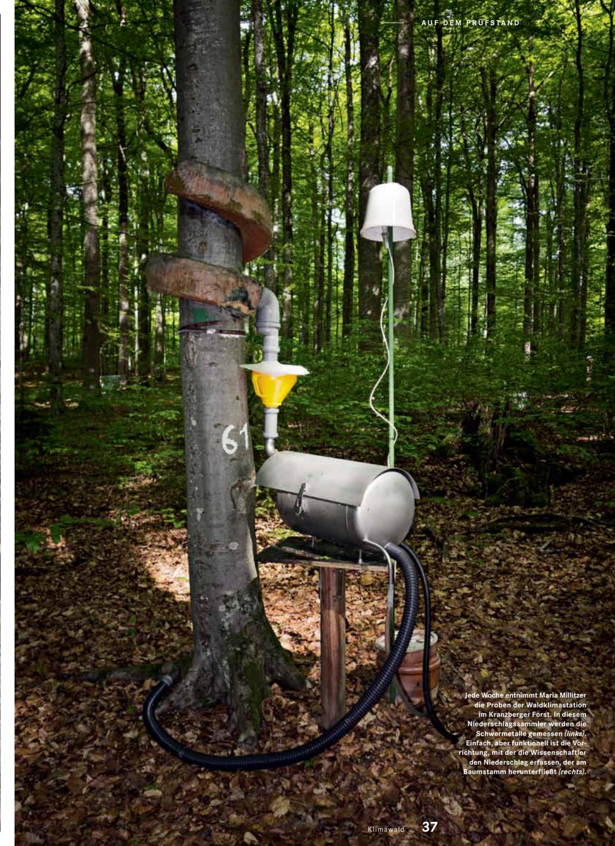
Jede Woche entnimmt Maria Millitzer die Proben der Waldklimastation im Kranzberger Forst. In diesem Niederschlagsammler werden die Schwermetalle gemessen (*links*). Einfach, aber funktionell ist die Vorrichtung, mit der die Wissenschaftler den Niederschlag erfassen, der am Baumstamm herunterfließt (*rechts*).
