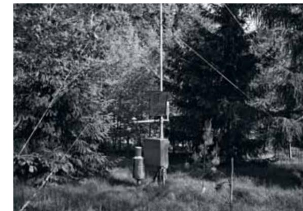
Mit der elektronischen Niederschlagswaage wird die exakte Menge von Regen, Tau, Hagel oder Schnee auf der Freifläche erfasst (links).
