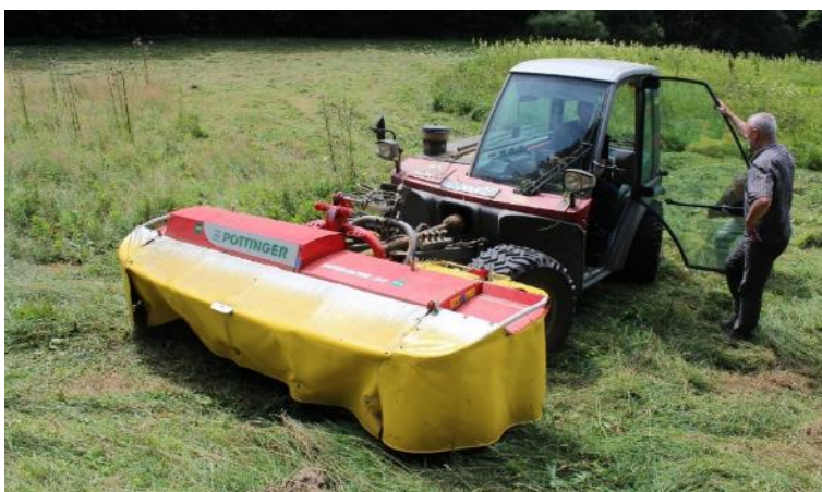
Abbildung 38: Pflege von Feuchtgrünland durch Spezialmaschine mit Breitreifen im Revier Wolfersgrün (A.Reichert)
